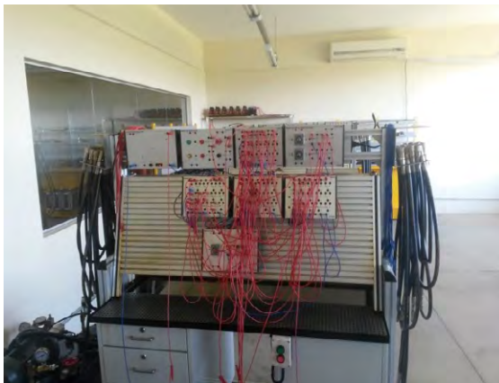
Figura 2: Controle da esteira por lógica de relés.
