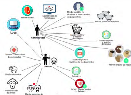
Figura 1. Diagrama de modelagem UML personalizado de Caso de Uso do Software SIGRO, com a função de mostrar as principais funcionalidades do sistema, de forma simples e objetiva.
