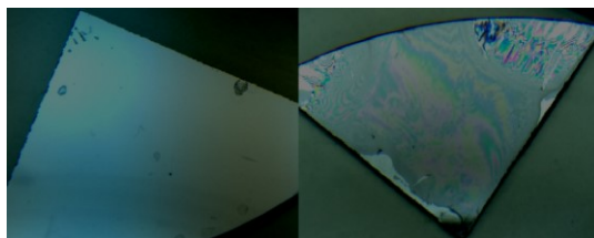
Figura 2. (a) Análise do substrato sem filmes depositado. (b) Análise do substrato com filmes depositado.
