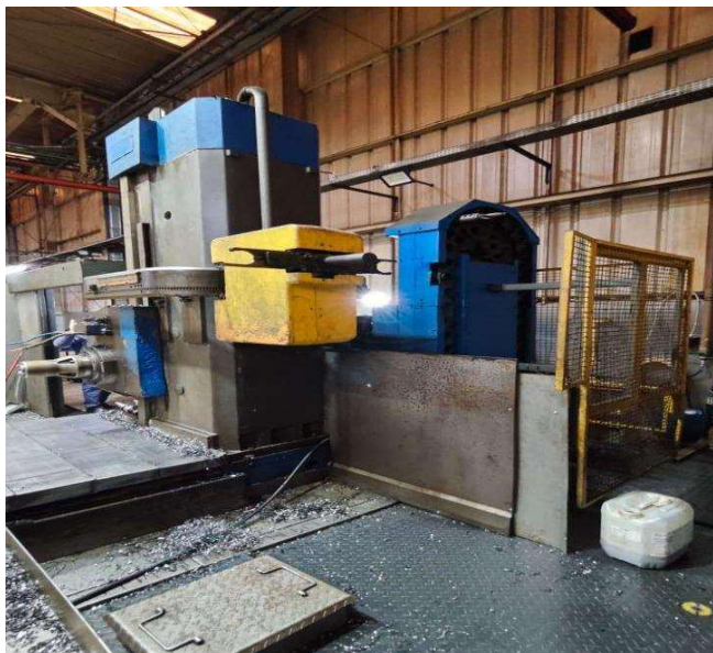
Figura 11: Imagem do sistema de troca automática de ferramentas junto ao magazine de armazenagem de 40 ferramentas ainda aguardando os termos da segunda etapa do retrofit.
