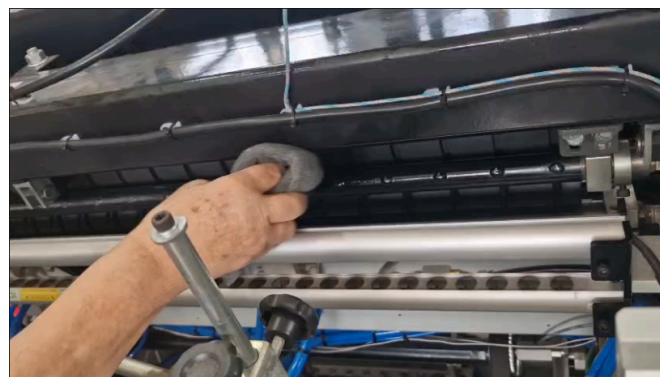
Fig. 5. Limpeza do Rolo de resíduos. Fonte: próprio autor (2025).
