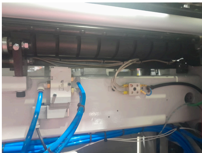
Fig. 4. Rolo de resíduos. Fonte: próprio autor (2025).
