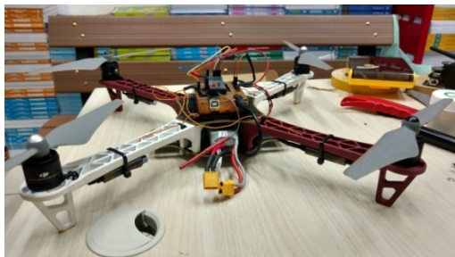
Figura 2. Quadróptero em fase final de construção.
