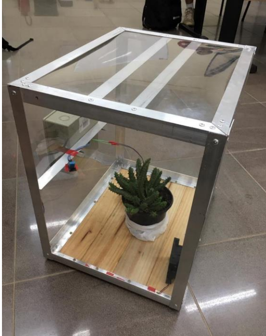
Figura 1 - Protótipo da estufa nos testes finais.
