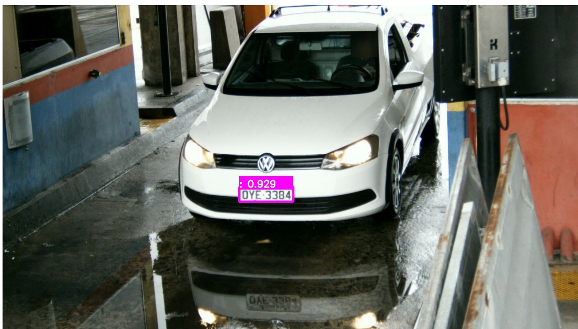
Figura 13 – Detecção de placa veicular com a confiança calculada pelo DNN
