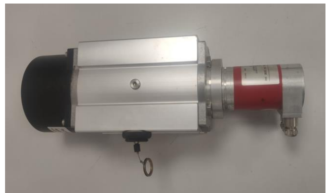
Fig. 10. Modelo de encoder com enrolador de espia.
