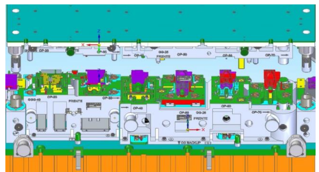
Fig. 2. Exemplo de ferramenta de estampo aberta.
