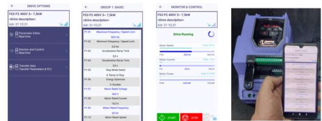
Fig. 7. Programação inversor de frequência da série Optidrive.
