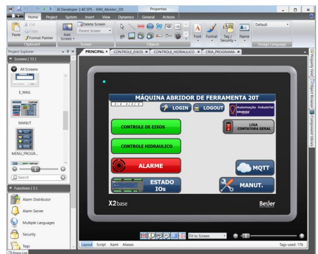
Fig. 14. Visão geral software IHM iX Developer e tela menu principal.
