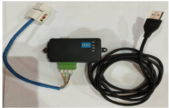
Fig. 1. Conversor USB com TIA/EIA-485.
