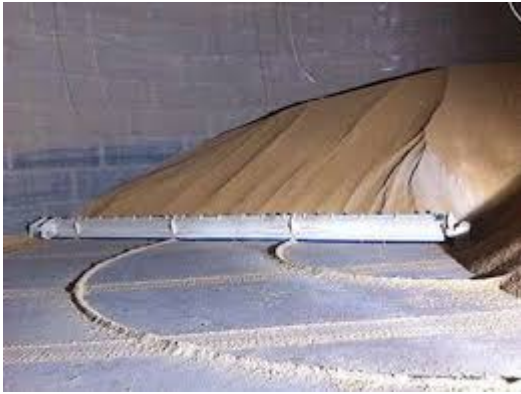
Fig. 6. Talude de grãos na descarga e o trajeto da rosca varredora. Fonte: https://www.morillonsystems.pt/spirogyre/ 2023.
