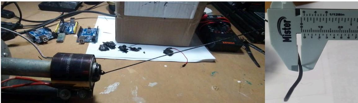
**Figura 7. Filamento de ABS extrusado (esq); Aferimento da espessura do filamento extrusado com paquímetro. Diâmetro de 1,6mm (dir.).**
