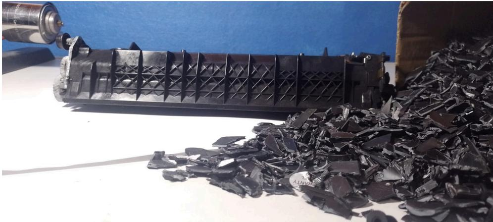
**Figura 6. Plástico ABS proveniente de cartuchos de toner sendo preparados para extrusão.**
