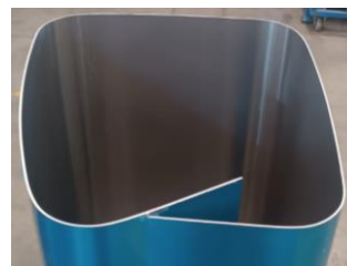
Figura 4: Exemplo de tanque calandrado torto.
