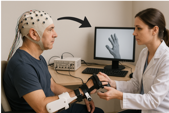
Fig. 14. Exemplo de BCI aplicada à reabilitação motora, com EEG, imagética motora e controle de dispositivo robótico assistivo [33].
