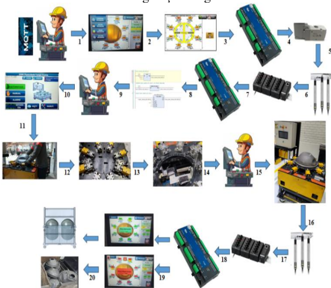
Fig.7. Elaborado pelo autor (2025). Descrição visual resumida do processo de Medição planicidade da tampa.
