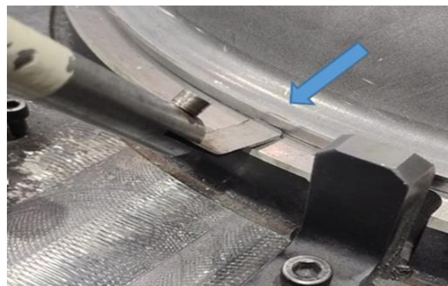
Fig. 2. Calibre de folga para controle planicidade.
