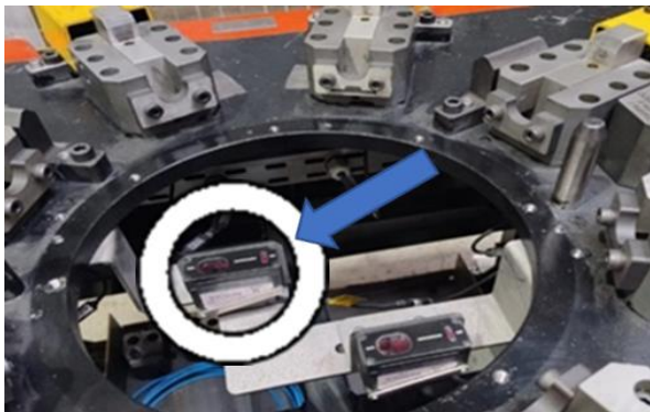
Fig. 18. Posicionamento 2 sensores presença de peça.
