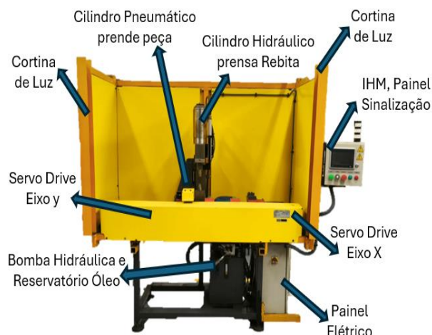
Figura 19. Máquina atual de rebite para travessa.
