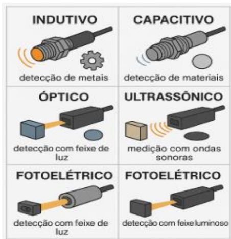
Figura. 4. Tipos de sensores industriais e seus princípios de funcionamento.
