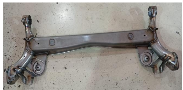
Figura 3: Peça final que é produzida na célula de soldagem em estudo.
