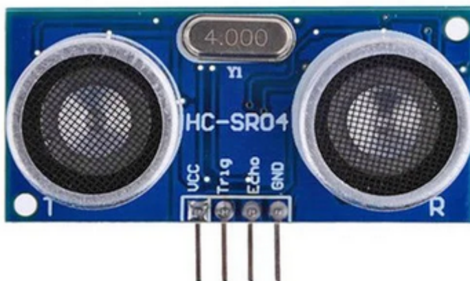
Figura 4 - Sensor de presença ultrassônico HC-SR04, percebe a movimentação através de ondas sonoras.
