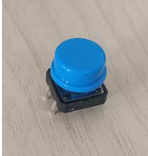
Figura 9 - Botão, apertando ele uma ação pré programada irá ser executada.
