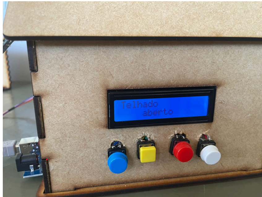
Figura 24 – Imagem da impressão na tela do telhado aberto.
