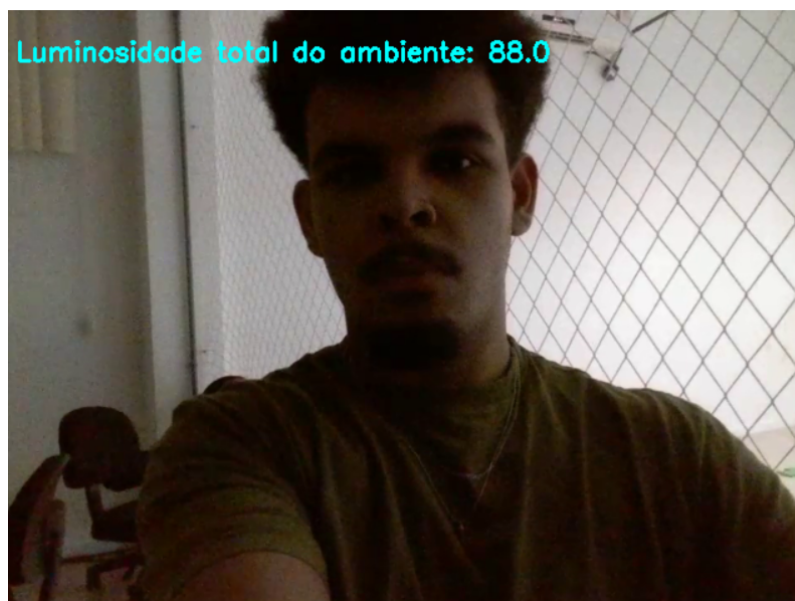
Figura 4. Falha de detecção devido a sombras parciais
