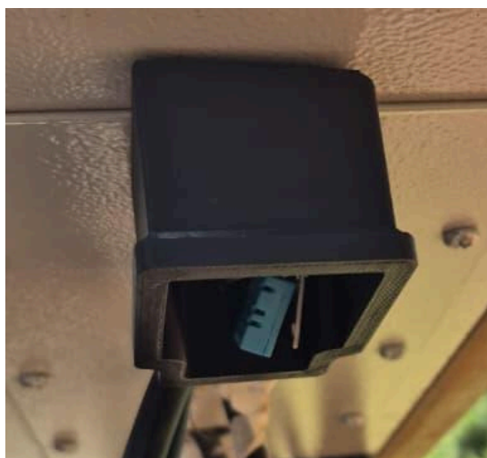
Figura 8. Adaptação externa do sensor para correção de leitura térmica
