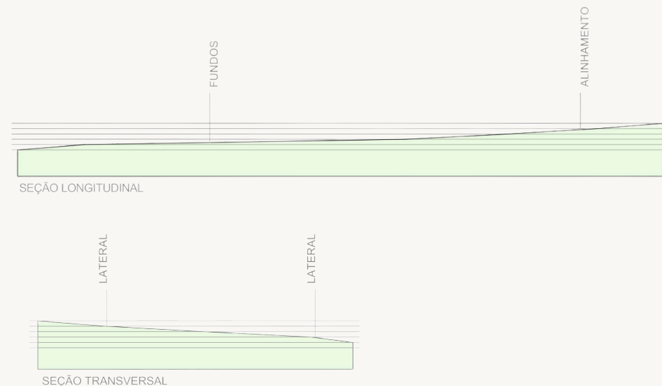
Figura 02: Desnível transversal e longitudinal do sítio. Da autora (2024)
