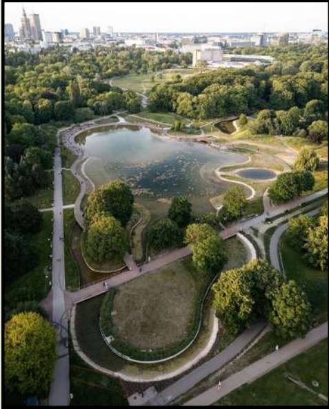
Figura 268: Bacias de Retenção, conectividade e traçado.
