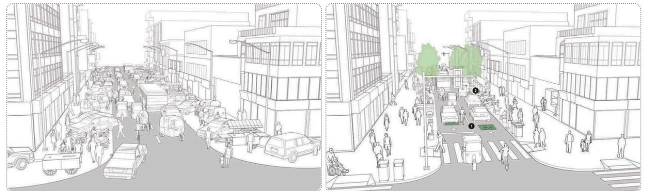
Figuras 62 e 63: Remodelação de uma rua central de mão dupla, através das orientações do GGDR. Fonte: GDCI, 2018.
