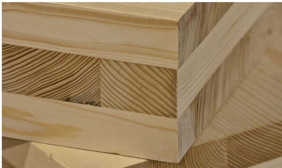
Figura 122: Imagem chapa de CLT Fonte: Archdaily, 2024.
