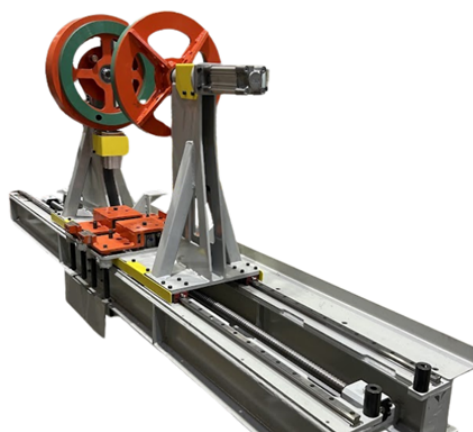
Figura 17 - Montagem da estrutura mecânica do dispositivo
