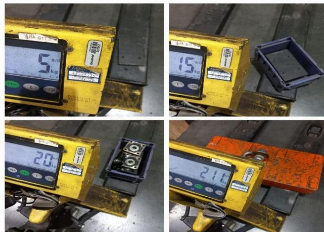
Fig. 11. Verificação dos pesos para o teste de carga. [18]
